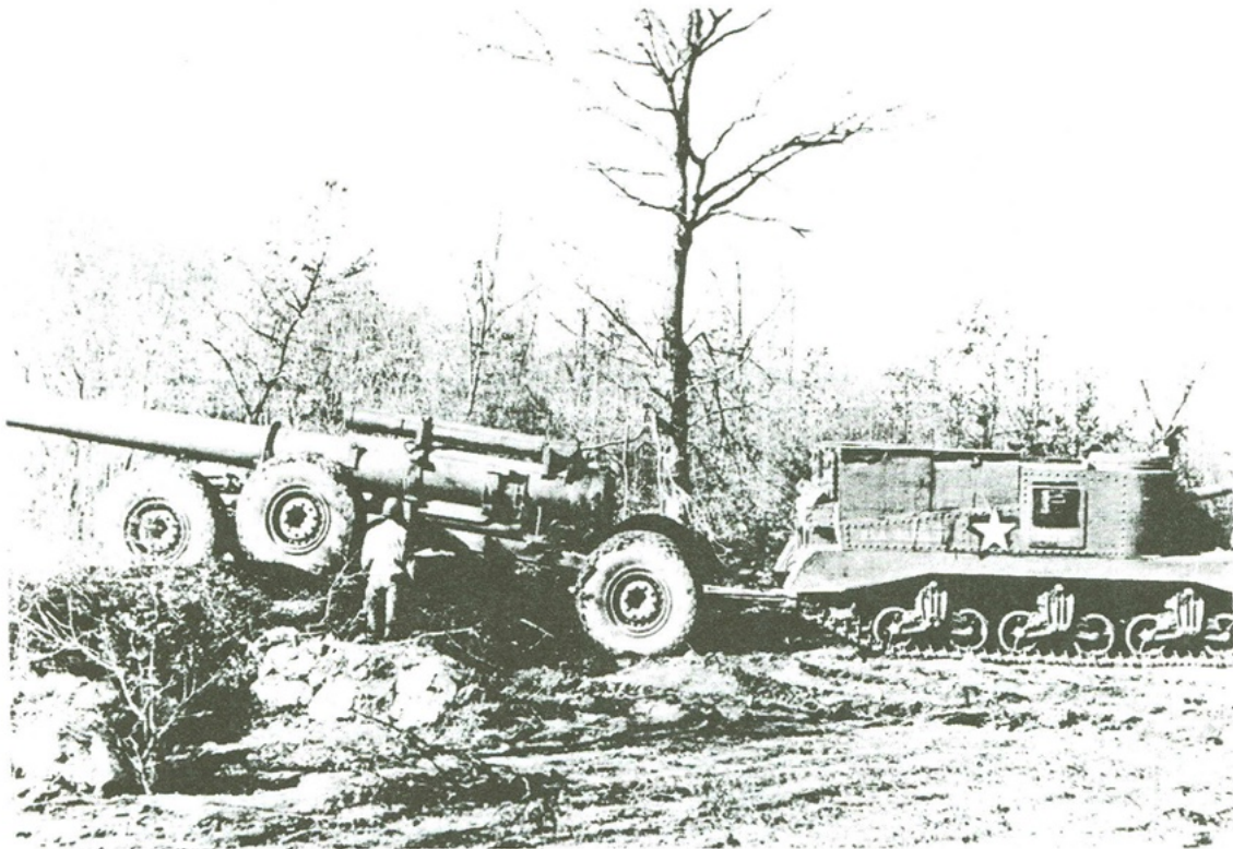
De loop van een 240 mm howitzer op zijn transportwagen, getrokken door een M33 Prime Mover (een vroegere M3 Lee tank).
